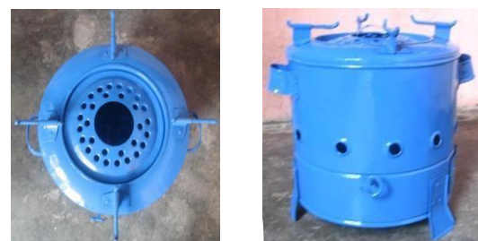
Gambar 1. Modifikasi kompor briket batubara (a) Tampak atas, (b) Tampak depan
