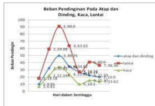
Gambar 8. Sumber Beban Pendinginan Aktual Pada atap, dinding, lantai dan kaca.
