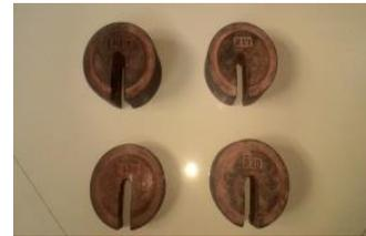
**Gambar 2.** Beban pada mesin uji lelah (*fatigue*)
