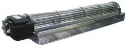
Ketika AC dinyalakan, maka blower indoor ini akan berputar. Tujuannya yaitu untuk menghisap udara di dalam ruangan dan menghembuskan udara ke ruangan tersebut. Jadi intinya, blower indoor bertugas sebagai sirkulator udara di dalam ruangan yang ber-AC sehingga udara bisa bersirkulasi secara kontinu melewati evaporator.
