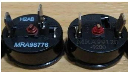
Overload berfungsi sebagai sensor aliran listrik yang akan dikonsumsi oleh motor listrik kompresor. Jadi ketika arus listrik yang mengalir ke kompresor sangat tinggi secara continue, maka overload ini akan secara otomatis memutuskan arus listrik tersebut sehingga alat ini dapat memastikan bahwa kompresor selalu bekerja dalam keadaan normal.
