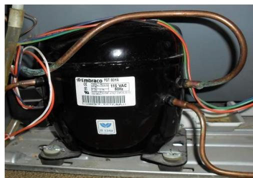
Kompresor mempunyai tugas untuk mensirkulasi dan memompa refrigerant tersebut. Selain itu, juga membuat dua sirkulasi sistem berbeda tekanan agar mempermudah proses refrigerant tersebut untuk berubah fasa dari cair menjadi gas atau gas menjadi cair selama proses sirkulasi operasional AC.
