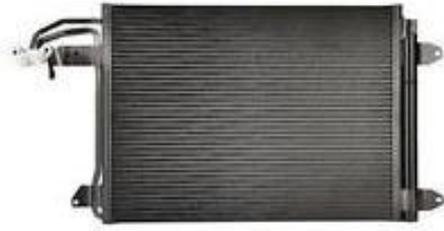
Pada saat zat refrigeran mulai meninggalkan kompresor dan menuju ke kondensor, maka zat refrigeran tersebut akan memiliki kalor, suhu dan tekanan yang tinggi. Fungsi dari kondensor ini adalah untuk mendinginkan zat refrigeran tersebut dan menurunkan tekanannya. Selain itu, juga berperan untuk merubah fasa zat refrigeran dari gas menjadi cair kemudian dialirkan ke orifice tube/pipa kapiler.
