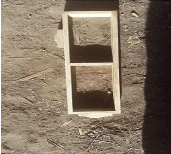
Gambar 1. Alat pencetak batu bata sistem tradisional
