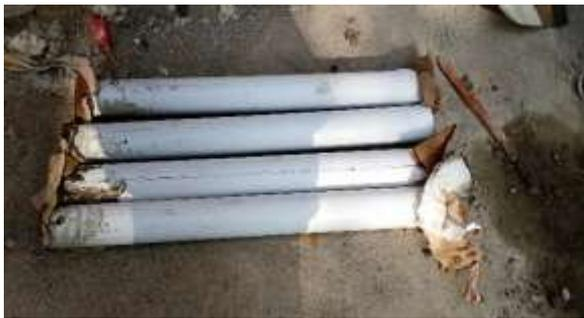
Gambar 5. Patok beton dengan menggunakan abu sekam padi
