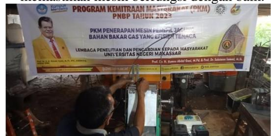
Gambar 5.4 Merakit mesin pencacah rumput
