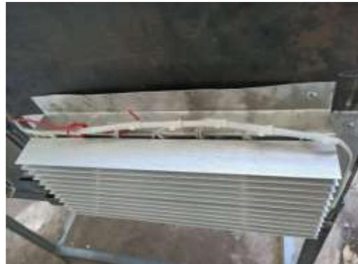
Gambar 8. Elemen termoelektrik dan pendingin (*heatsink*),
