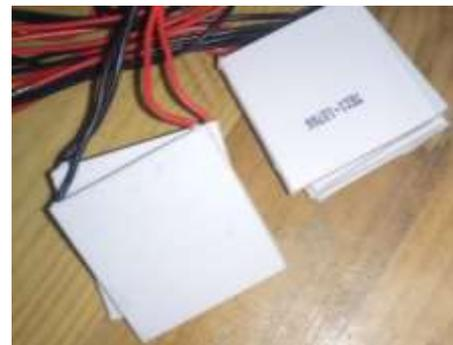
Gambar 9. Elemen Termoelektrik (Peltier )
