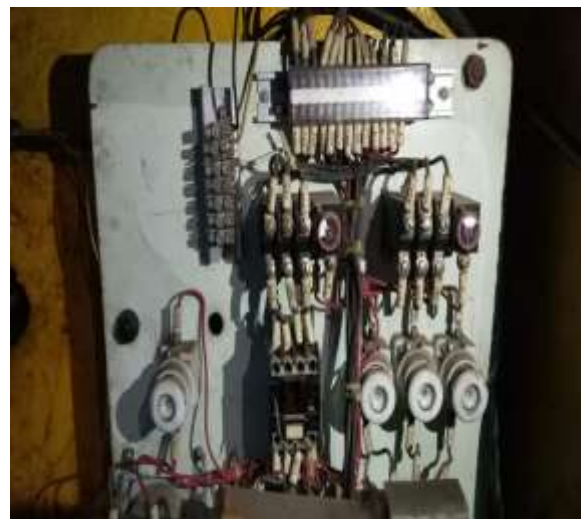
Gambar 4. Menjelaskan system kelistrikan mesin bubut
