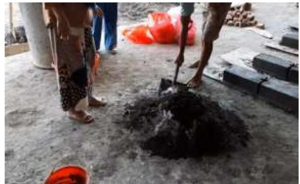
Gambar 3. Proses pengadukan bahan pembuatan batako
