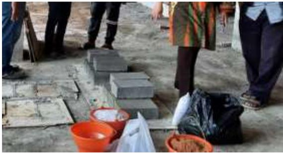
Gambar 5. Hasil batako yang telah selesai dicetak dan dikringkan
