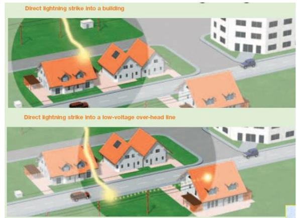
Gambar 8. Gambar bangunan dan jaringan listrik yang di sambar petir
