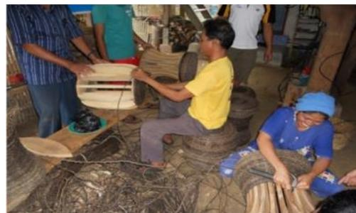
Gambar 12. Proses pembuatan kursi dan meja antik dari tangkai buah enau
