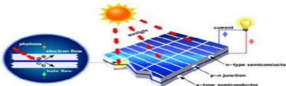
**Gambar 1.** Skema konversi energi surya menjadi energi listrik
