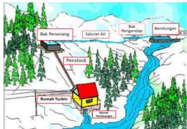
Gambar 2. Skema Pemanfaatan Energi Potensi Air Sebagai Penggerak Turbin Pembangkit Listrik
