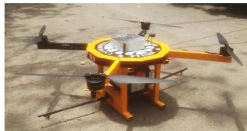
Gambar 1. *UAV quadcopter* Pemupuk
