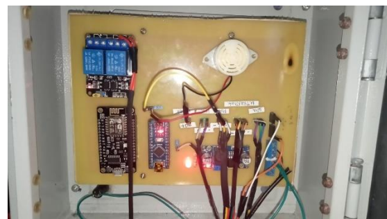
Gambar 7. Rangkaian kontrol rak bunga pintar
