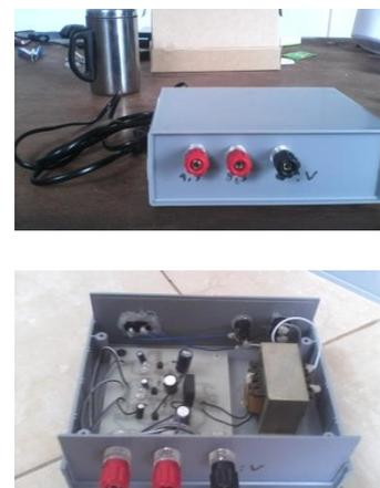
Gambar 7. Hasil pembuatan power supply
