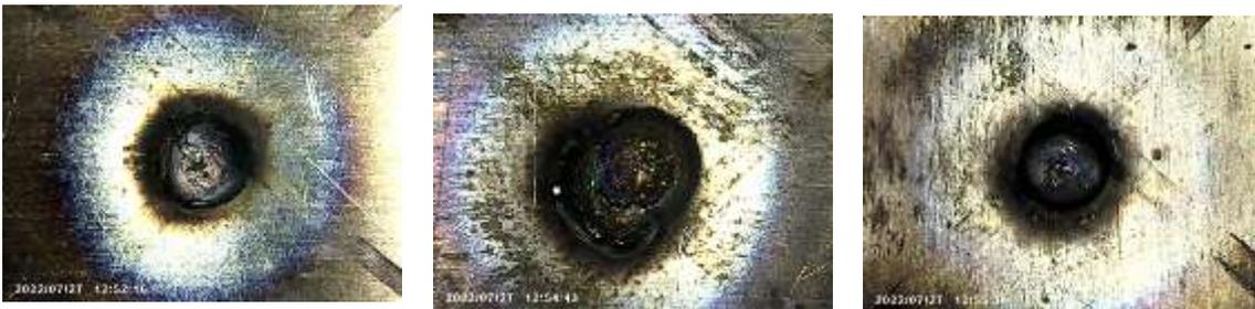
Gambar 9 Sampel 1,2 dan 3 setelah Foto Makro untuk Kuat Arus 7kA
