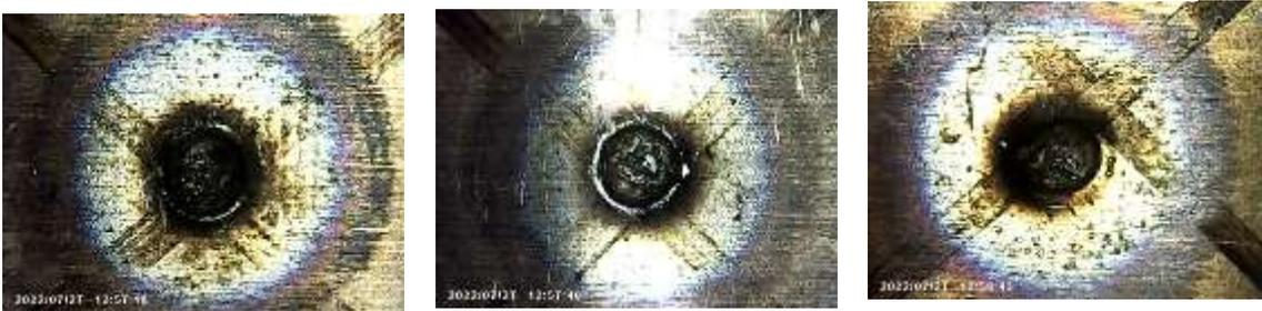
Gambar 8 Sampel 1, 2 dan 3 setelah Foto Makro untuk Kuat Arus 5kA
