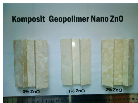
Gambar 1. Prototip sampel geopolimer nano ZnO yang diproduksi untuk uji lentur
