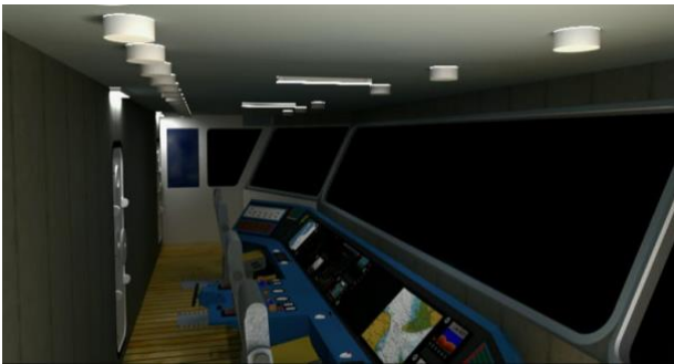
Gambar 5. Simulasi Penerangan ( Navigation Deck ) menggunakan lampu LED (Kondisi Darurat)
