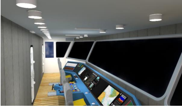
Gambar 4. Simulasi Penerangan ( Navigation Deck ) menggunakan lampu LED (Kondisi Normal)
