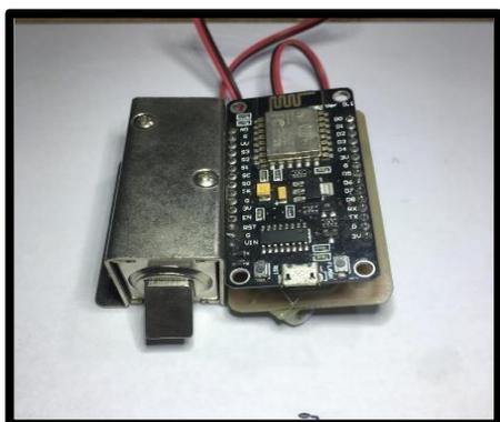
Gambar 18. Pengujian Selenoid
