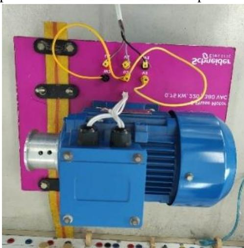
Gambar 2. Motor 3 fasa pada *Forward-Reverse*
