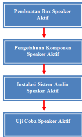
Gambar 14. Prosedur project work pembuatan speaker aktif
