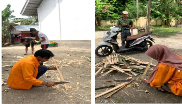
**Gambar 4.** Proses Pemotongan dan Pembersihan Serat Bambu
