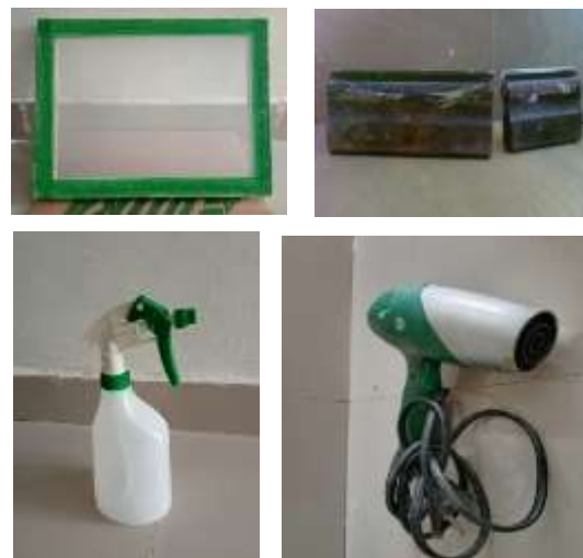
Gambar 1. Peralatan Cetak Sablon (Atas kiri dan searah jarum jam: Alat Screen , Raket, Hair dryer dan Semprotan air)
