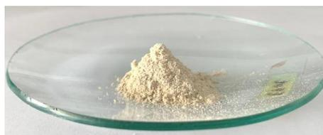
**Gambar 2.** Hasil Sintesis Komposit Zeolit-PbO
