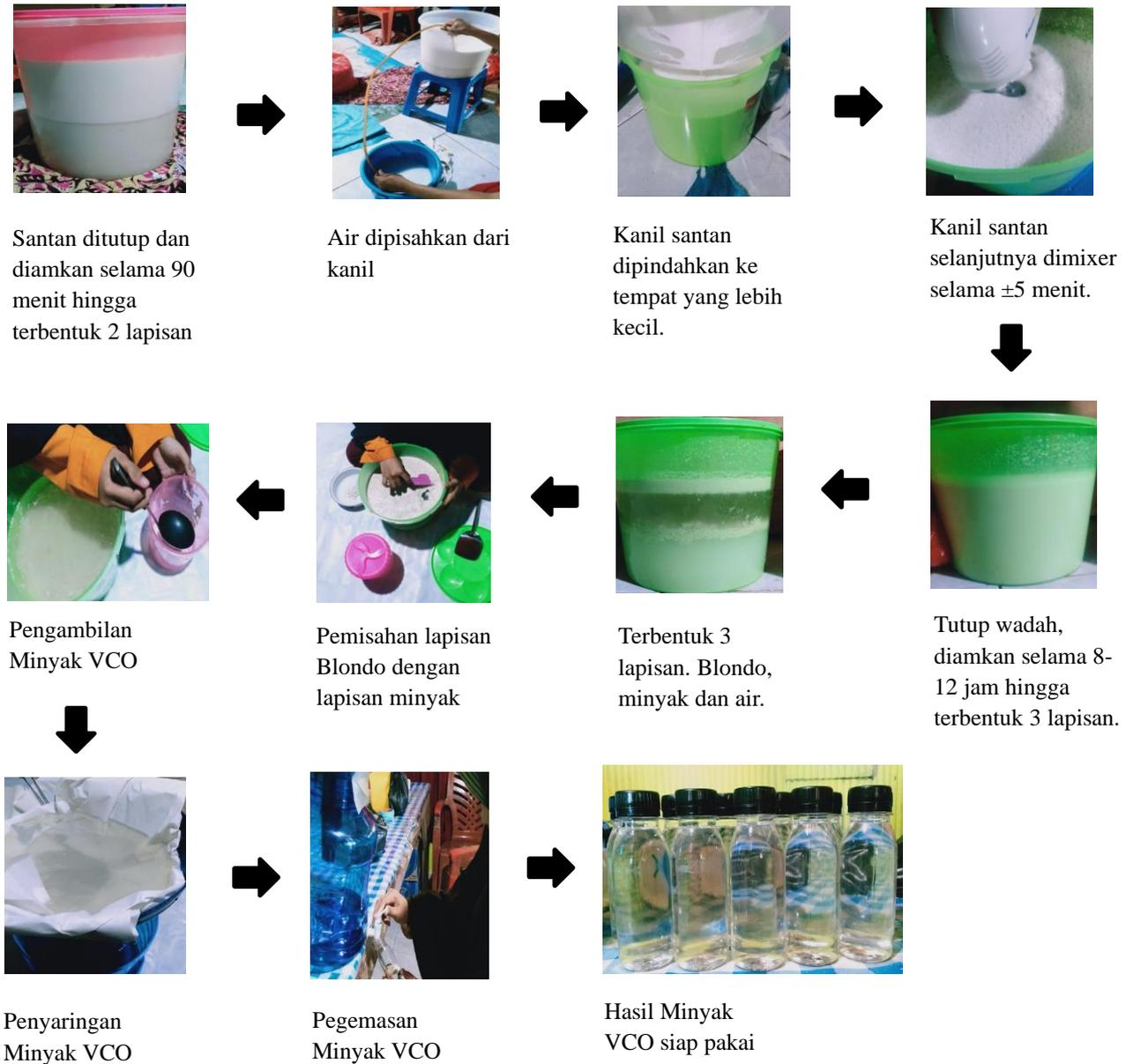
Gambar 1. Skema Pembuatan VCO
