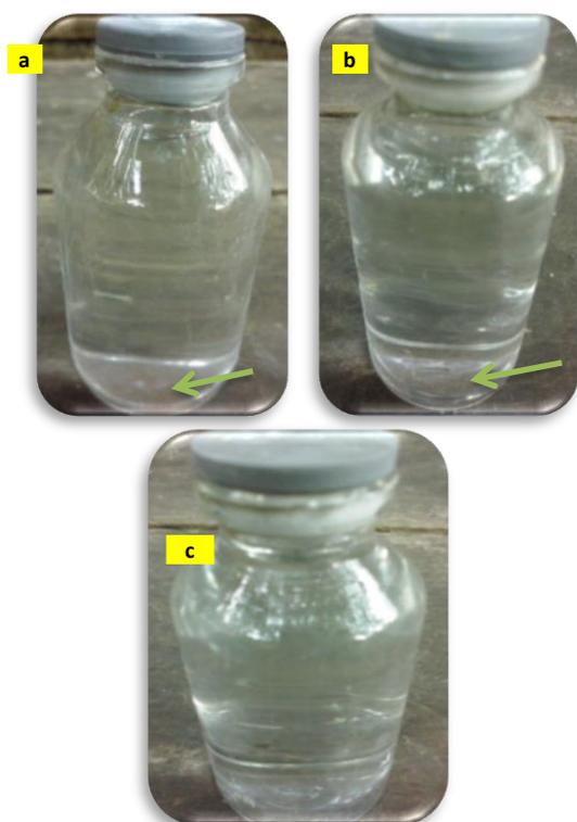
**Gambar 6.** Hasil Uji Air sebelum difilter (a), Filter Tunggal (b), dan Filter Ganda (c)
