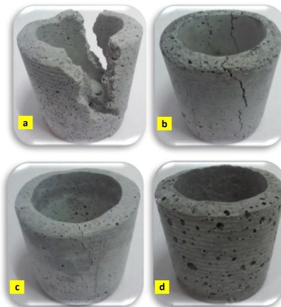
**Gambar 2** Filter Keramik dengan variasi Aluminium Foil (AF) 0,4 g (a), 0,2 g (b), 0,1 g (c) dan 0,75 g (d).
