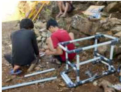
Gambar 4. Proses Pembuatan Kerangka Tempat Sampah
