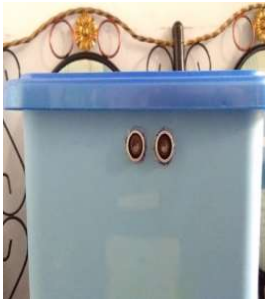
Gambar 4. Posisi Letak Sensor Ultrasonik pada Tempat Sampah
