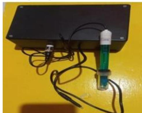
Gambar 4.1. Alat pemantau kualitas air IoT menggunakan pH sensor dan tds
