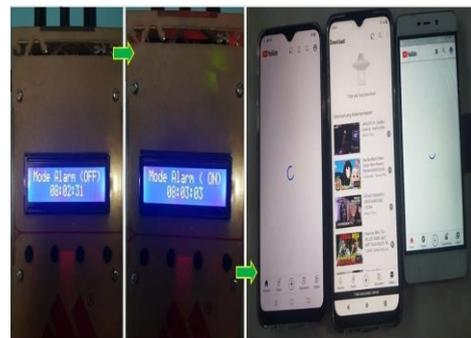
Pada gambar 11 hasil pengujian kedua pada jarak 2 meter. Jammer *OFF* pada pukul 08.02.31 dan *ON* pada pukul 08.03.00. Ketika jammer pada posisi aktif maka handphone mulai terblock. Dari hasil pengamatan, waktu respon handphone terhadap jammer pada jarak 2 meter untuk pengujian kedua adalah 103 Detik untuk telkomsel, 80 detik untuk Smartfren, dan 217 untuk indosat. Pada jarak 2 meter merupakan jarak maksimal yang dapat dijangkau *jammer* terhadap *provider* indosat.
