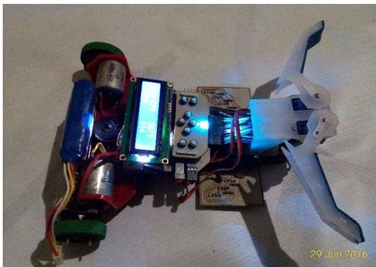
Gambar 2. *Line Follower* dengan tambahan motor servo & gripper
