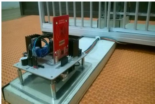
Gambar 2. Produk buka tutup gerbang menggunakan RFID berbasis Arduino Uno
