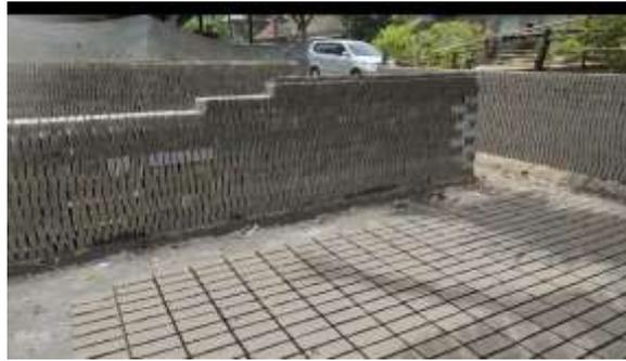
Gambar 1. Areal penyusunan batu bata sebelum proses pembakaran
